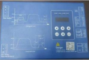
贝斯特门机变频器，同步机+编码器 距离控制，信号端子对应关系：
