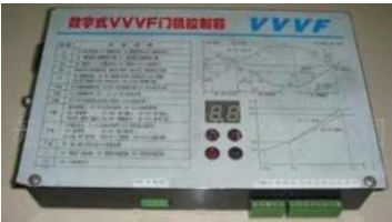
展鹏门机变频器，异步机 磁通矢量控制，信号端子对应关系：
